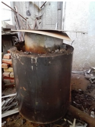
FOTOGRAFÍA 3. HORNO TIPO CRISOL PROVISIONAL QUE OPERA CON CARBON COMO COMBUSTIBLE
